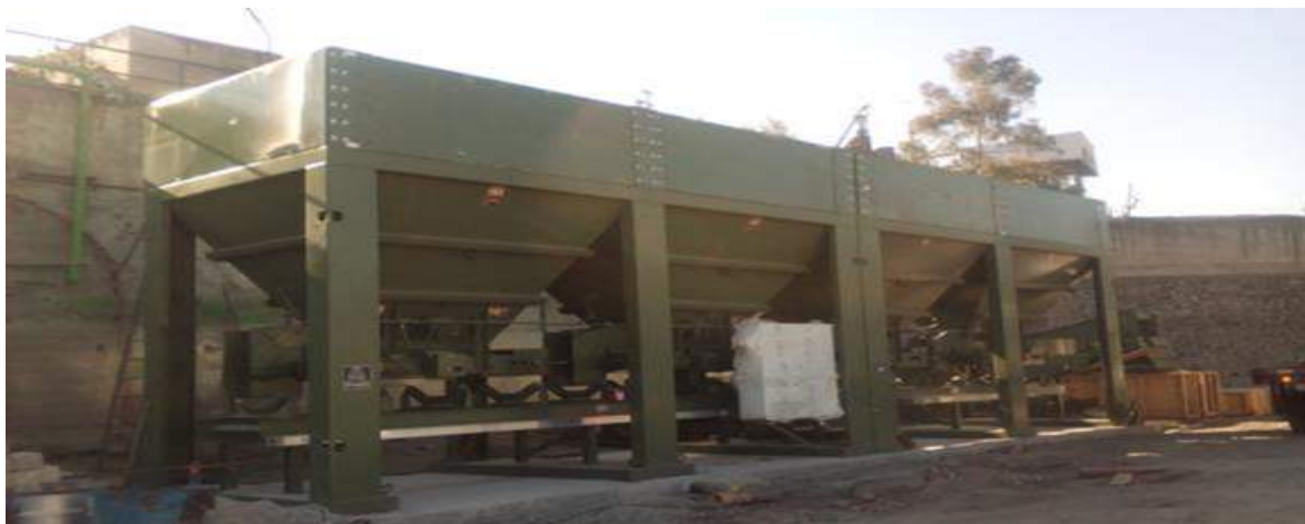
Tolvas de material virgen Planta No. 9
