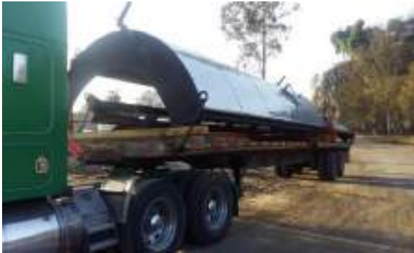
Cubierta del tambor mezclador
