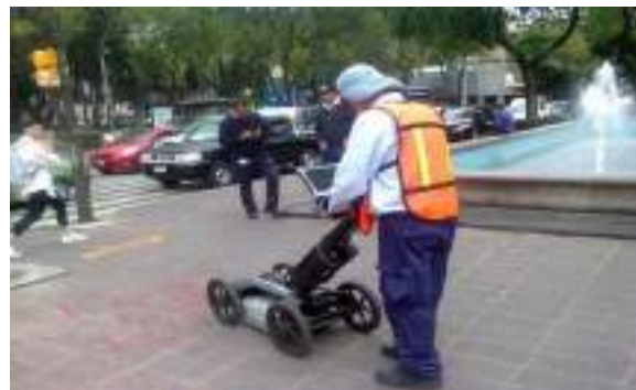
Georadar para instalaciones
