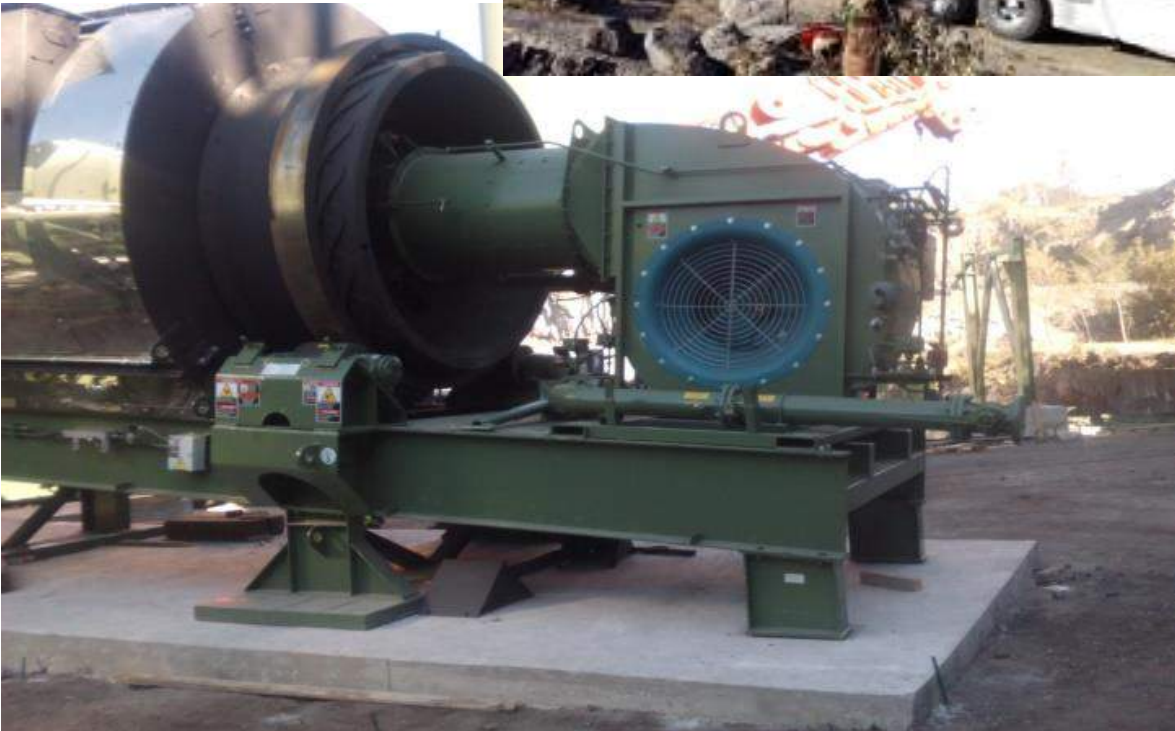
Nuevo quemador con capacidad de 125,000 BTU
