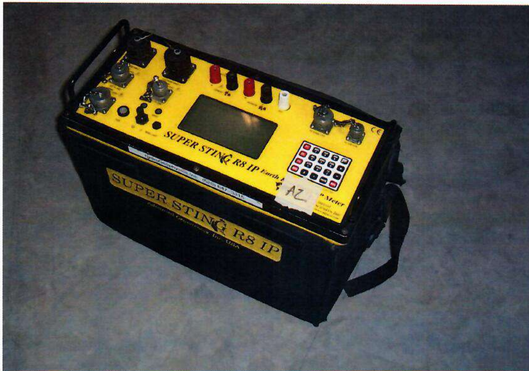
Figura 7. Equipo utilizado SuperSting R8
