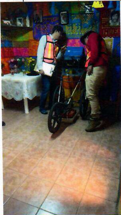
Adquisición RPT, casas dañadas 1
