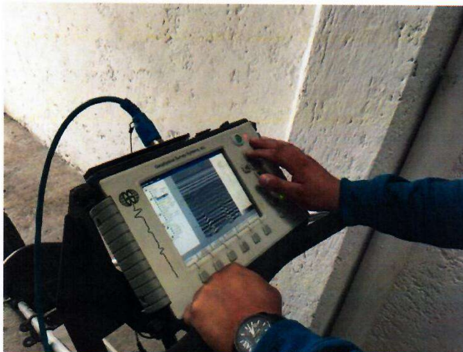
Figura 9. Adquisición de los perfiles de Radar de Penetración Terrestre (RPT)
