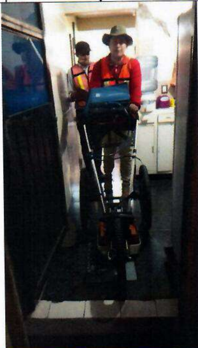
Adquisición RPT, casas Dañadas 4
