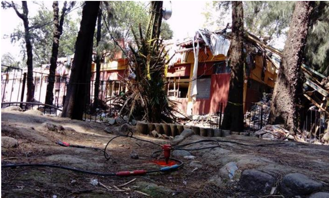
FOTOGRAFÍA 4. GEÓFONO HINCADO EN EL TERRENO FRENTE AL EDIFICIO COLAPSADO AL INTERIOR DEL SITIO DE ESTUDIO.
