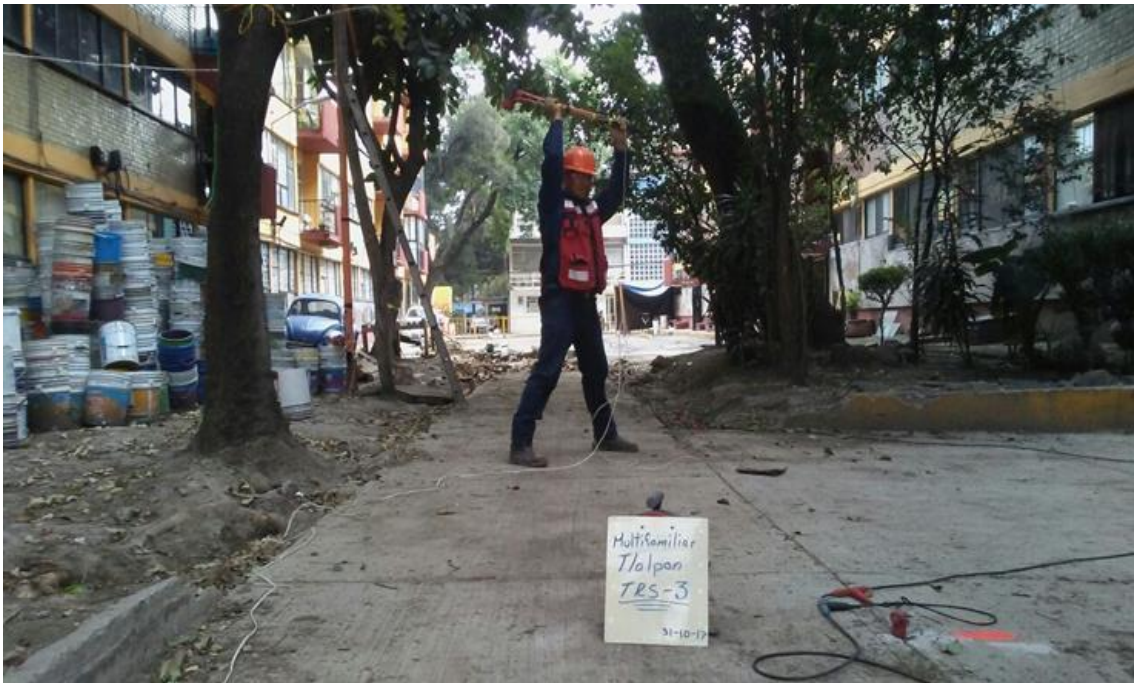
FOTOGRAFÍA 9. GENERACIÓN DE IMPACTO MEDIANTE USO DE MARRO, PARA EXCITACIÓN DEL TERRENO ENTRE LOS GEOFÓNOS 3 Y 4 DEL TRS-3.
