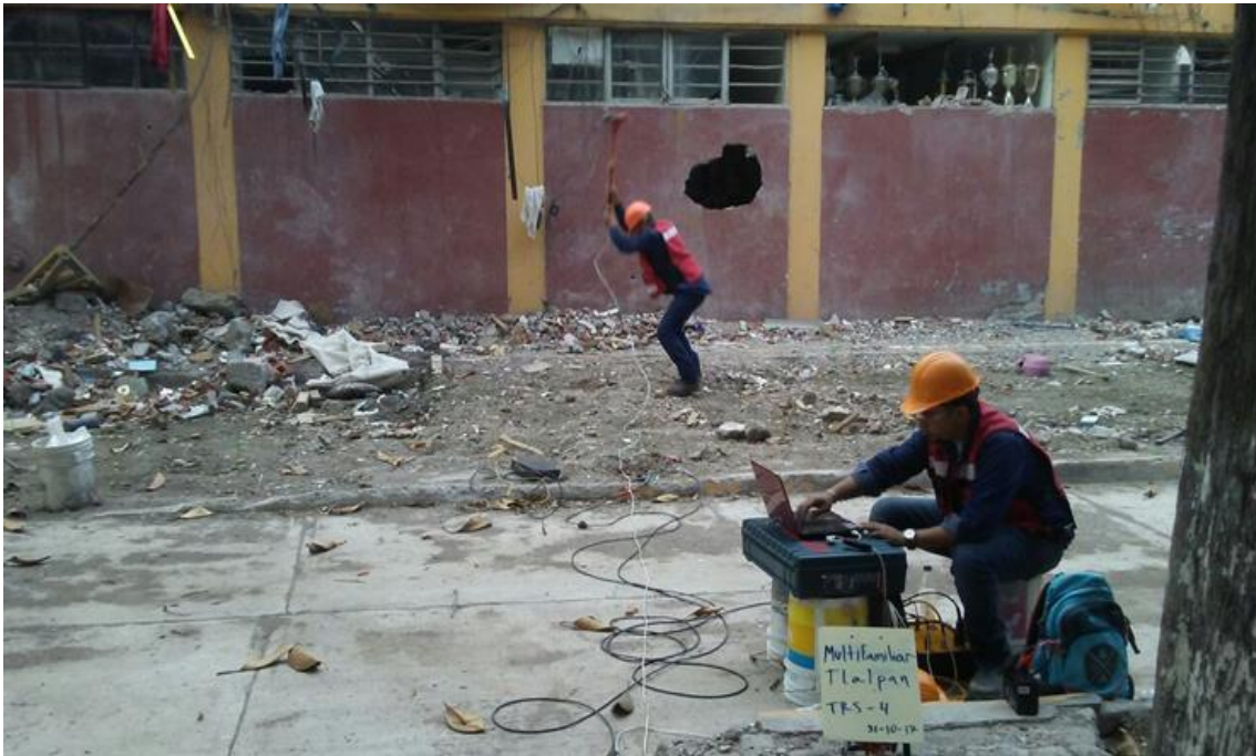
FOTOGRAFÍA 12. GENERACIÓN DE FRENTE DE ONDAS SÍSMICAS, MEDIANTE EL USO DE UN MARRO DURANTE LA ADQUISICIÓN DE DATOS GEOSÍSMICOS EN EL TRS-4.
