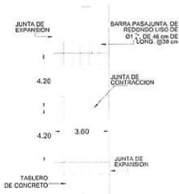
Figura II.72 Distribución de tableros en carriles centrales.
