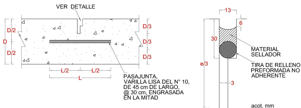
Fig. 10. Corte y sellado de juntas de contracción
