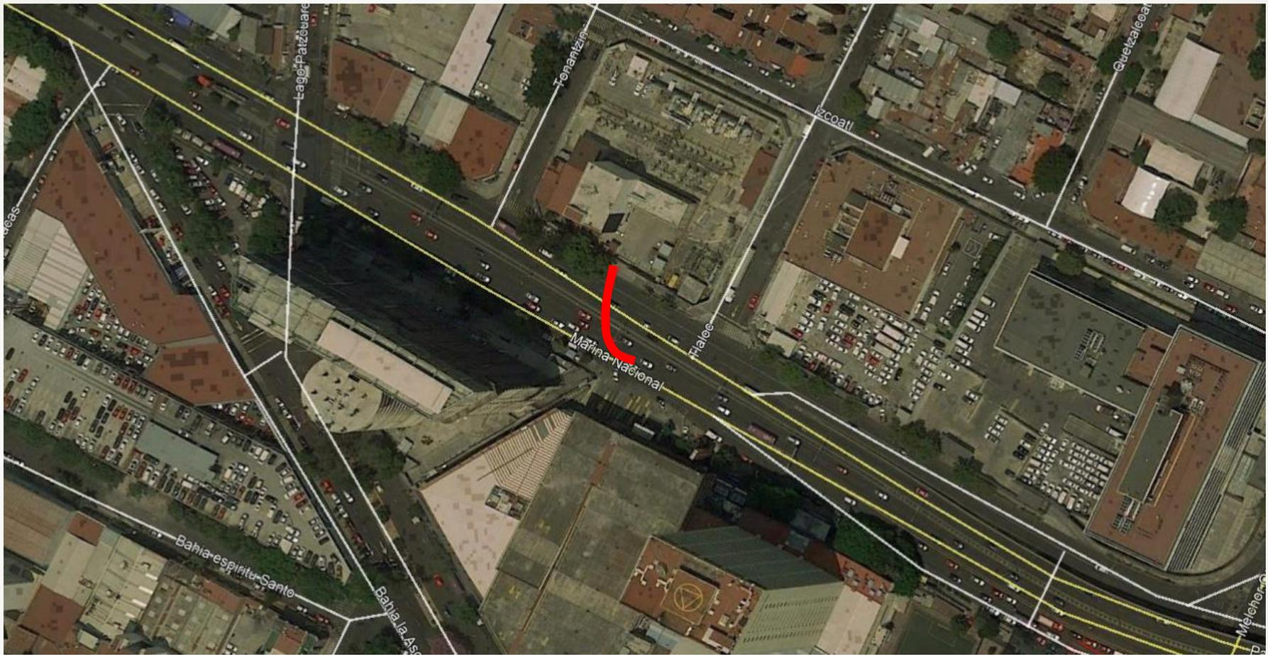
Construcción del **Banco de Ductos** a cielo abierto **50 m**, curva sobre Marina Nacional, afuera de la Subestación Eléctrica Verónica.
