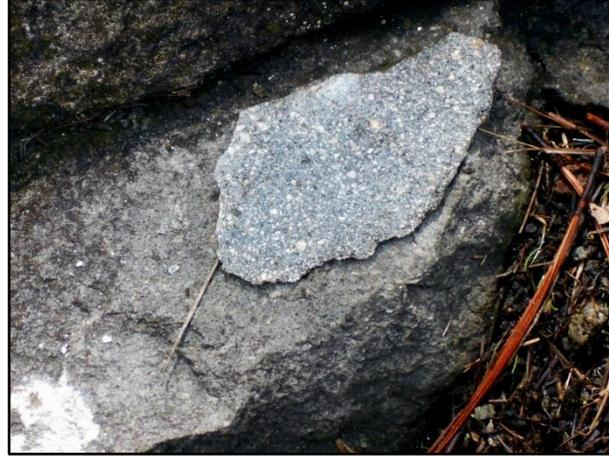
**Fotografías 6 y 7 mostrando en el lado izquierdo el afloramiento con diaclasas sub horizontales y en el derecho, un acercamiento de un ejemplar de mano de dacitas de textura porfídica color gris m. 42+500.**
