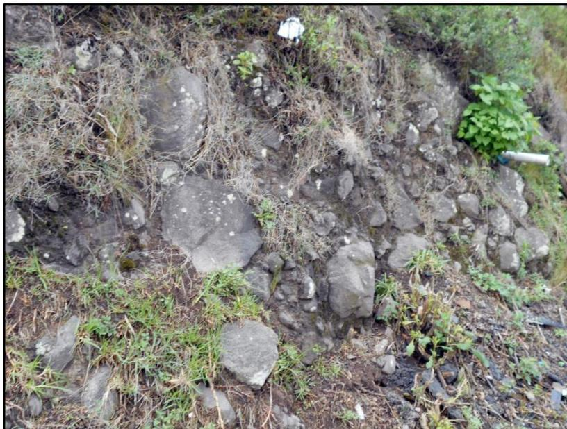
**Foto 8. Afloramiento típico de Brecha volcánica intemperizada Km. 42+620.**
