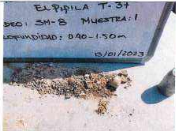
Foto No. 1.3 Detalle de muestra alterada obtenida a la profundidad de 0.90 a 1.50 m en el sondeo SPT-8.
