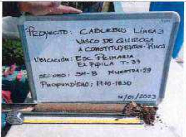
Foto No. 1.5 Detalle de muestra alterada obtenida a la profundidad de 17.70 a 18.30m en el sondeo SPT-8.
