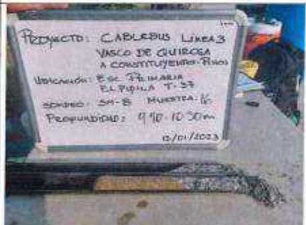
Foto No. 1.4 Detalle de muestra alterada obtenida a la profundidad de 9.90 a 10.50 m en el sondeo SPT-8.
