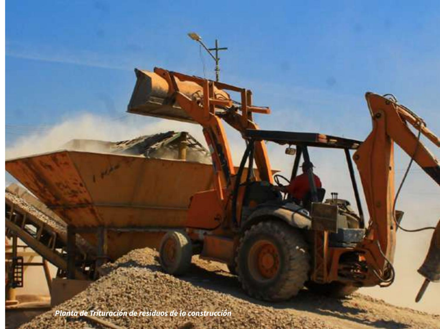
Planta de Trituración de residuos de la construcción
