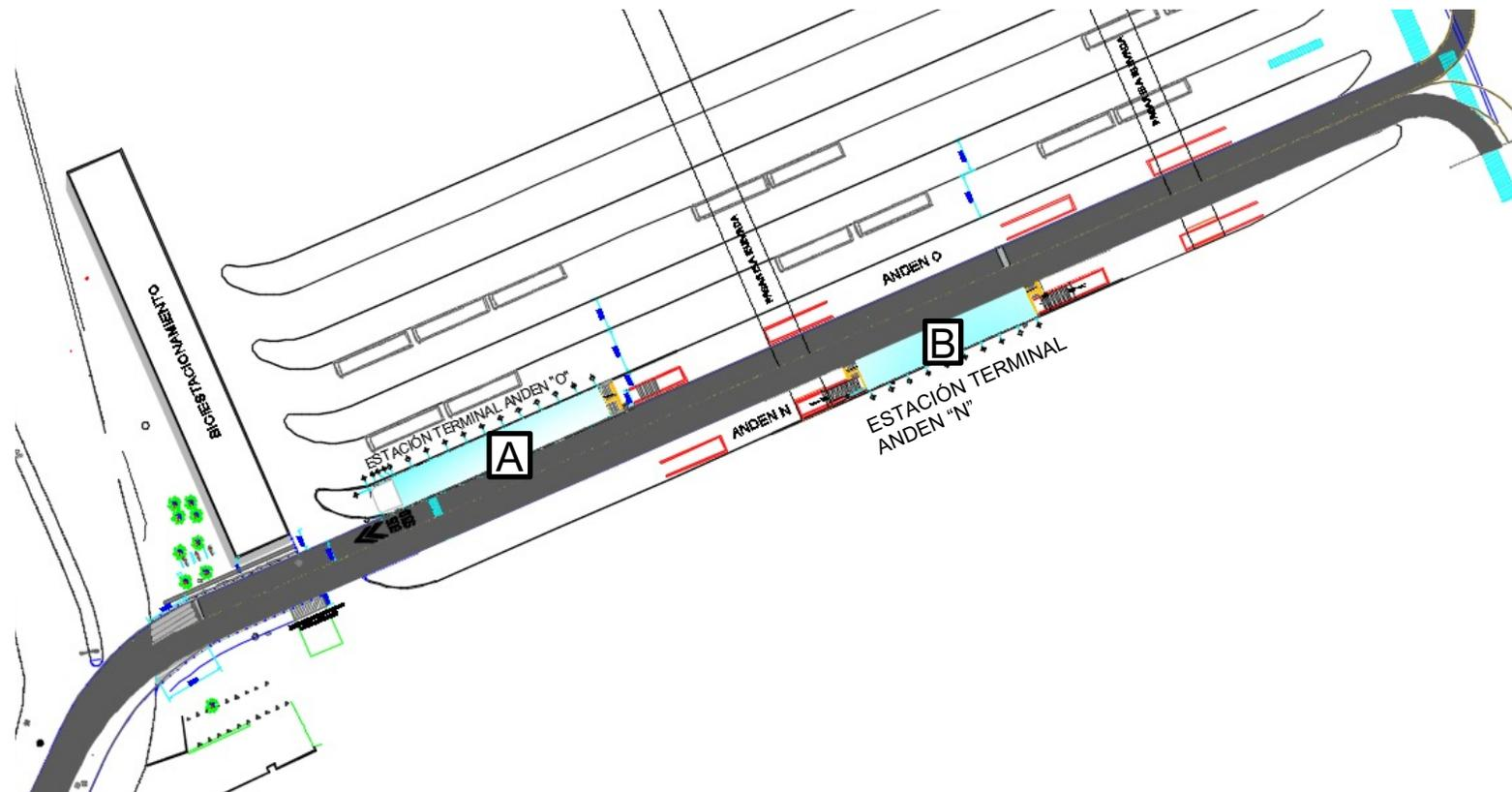
**Estación A** - Estación cerrada con cubierta, servicios, equipo de peaje y control de acceso en el **andén O**.
