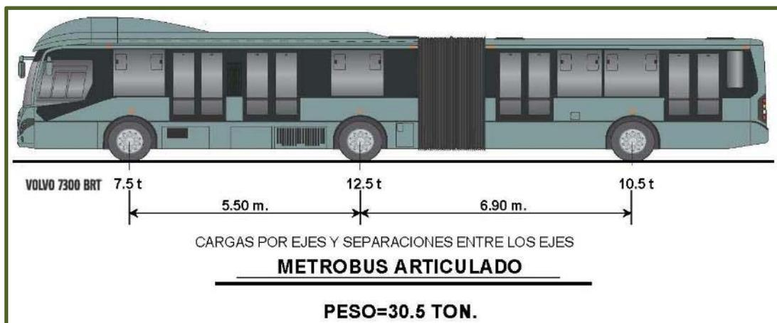
Figura No. 16.- Características de dimensiones y cargas para Metrobús articulado, marca VOLVO, modelo 7300 BRT.
