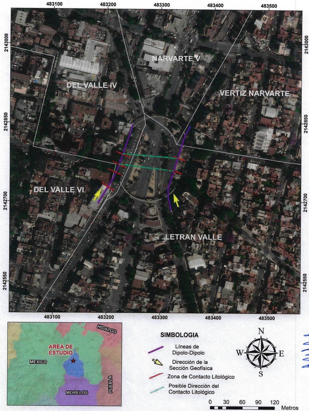
**Figura No. 2.3** Localización de las zonas de contacto sobre las líneas de tomografía eléctrica sobre Av. División del Nte - Av. Universidad.
