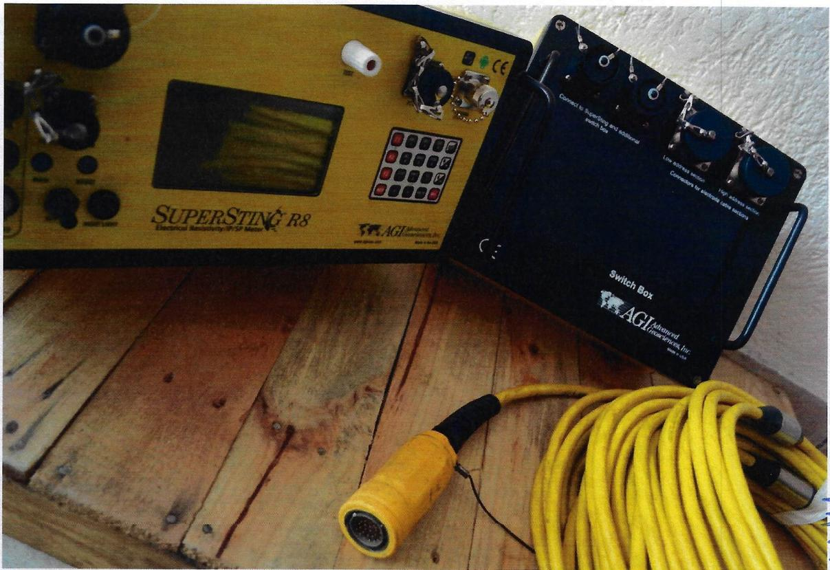
**Figura No. 2.1** Equipo de Exploración geoelectrica.
