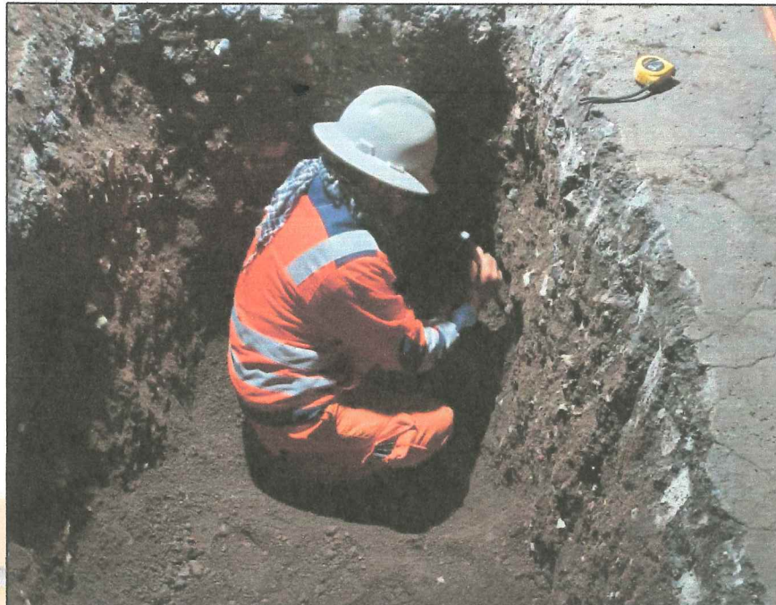
Figura 2.3. Vista de la recuperación de muestras de suelo
