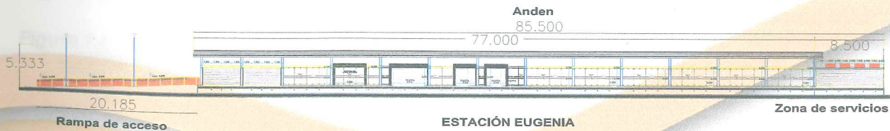
Figura 1.3. Vista en corte de la estación Eugenia
