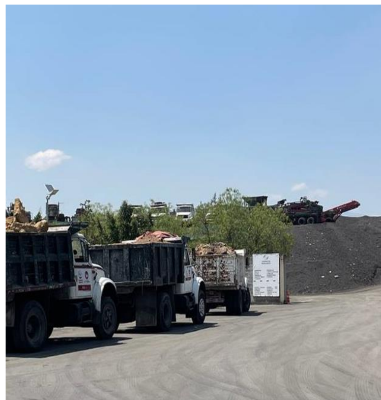
3.- Ingreso de los RCD a la PTARCD designada
