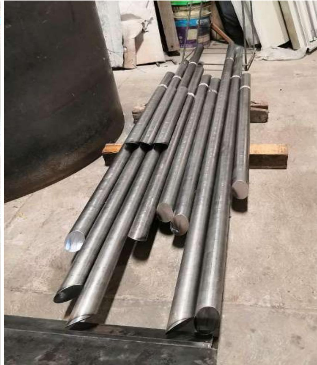
Corte de barras de 50 cm para realizar **pruebas de tensión**
