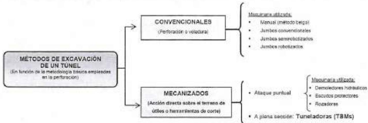
La excavación mecanizada logra esos objetivos, consiguiendo altos grados de mecanización y automatización del proceso mediante el sucesivo desarrollo de nuevas máquinas con nuevas tecnologías y la ayuda de técnicas constructivas complementarias.
