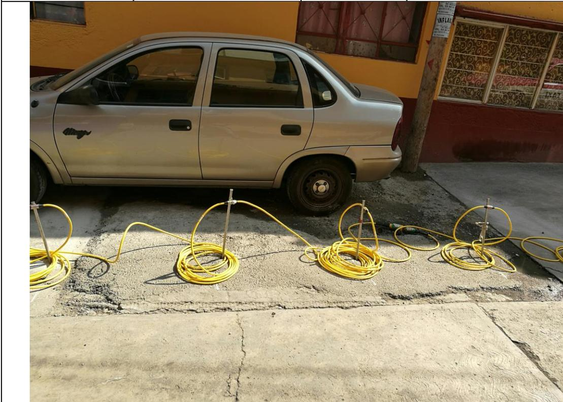
Varillas y cable multicanal TRE
