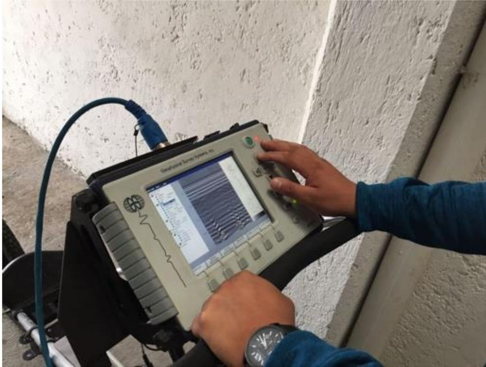
**Figura 9.** Adquisición de los perfiles de Radar de Penetración Terrestre (RPT)
